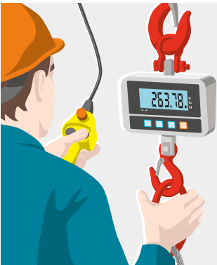
Regola 1 Determinare il peso e il baricentro del carico
