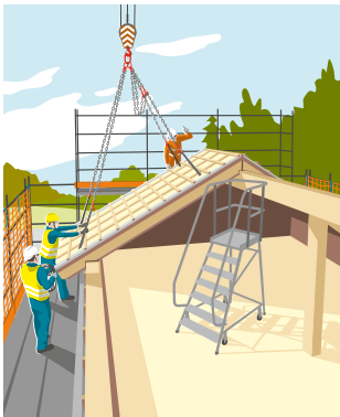
Regola 6 Imbracare correttamente il carico
