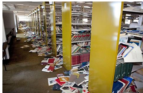
Abb. 2.22.5 und 2.22.6 &gt; Kippen mehrerer Regalreihen infolge des Domino-Effekts
